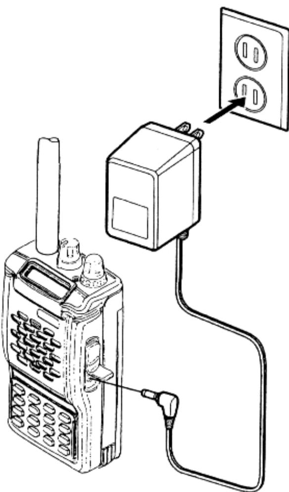
Если батарея раньше не использовалась или разрядилась в процессе работы, то Вы можете зарядить аккумуляторную батарею при помощи зарядного устройства NC -72C/F/U, подключив его к гнезду «Внешнее питание», как это показано на рисунке.
