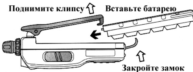
Для удаления батареи, выключите радиостанцию и снимите защитный чехол. Откройте замок батареи, затем нажмите на верхнюю часть клипсы, поднимите нижнюю часть батареи и удалите ее из радиостанции.
